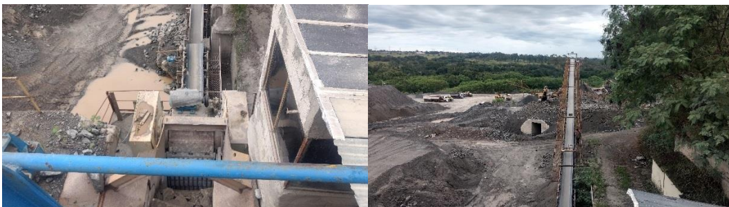
Figura 3: Britador da Pedreira Araguaia. A esquerda esteira transportadora a direita para o peneiramento do minério. Fonte: Fotos do autor.
