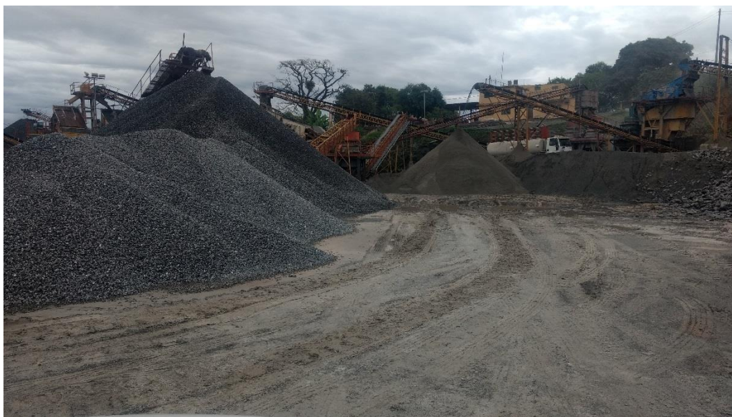
Figura 5: Pátio de estocagem. Pilhas de brita em diferentes classificações sendo formado. Fonte: Fotos do autor.
