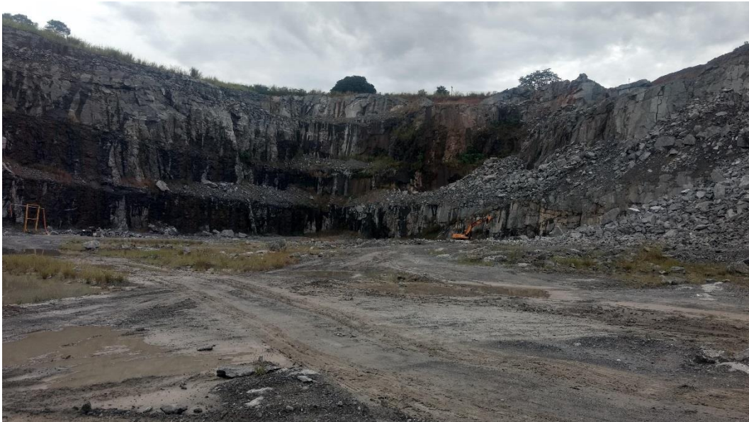
Figura 2: Área de Lavra, pós detonação. Minério sendo preparado pela escavadeira para carregamento e transporte por caminhão até a área de beneficiamento. Fonte: Fotos do autor.
