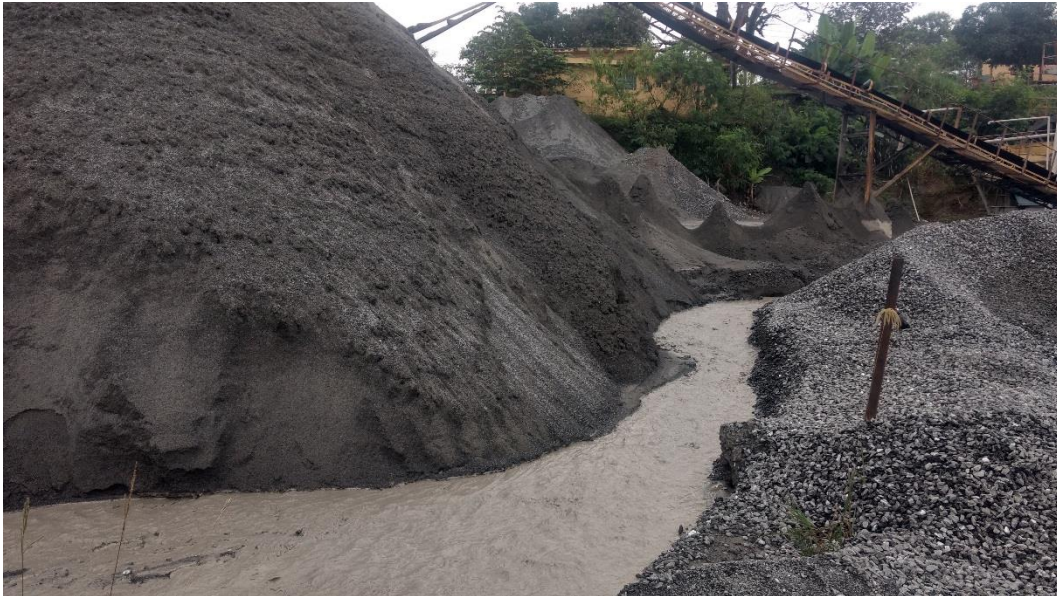
Figura 6: Drenagem do rejeito. Contendo sólidos em suspensão, oriundo da lavagem da brita, sendo direcionado para as bacias de decantação. Fonte: Fotos do autor.
